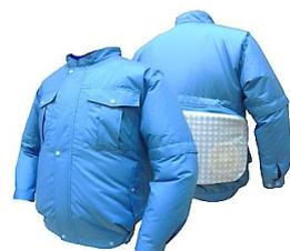
絶縁上衣を着用した場合でもファン部周りに空気流通スパーサーを設けている為、絶縁上衣の裾部から外気を取り込むことができます。また洗濯等メンテナンスがしやすいよう空気流通スパーサーは取外し可能です。
